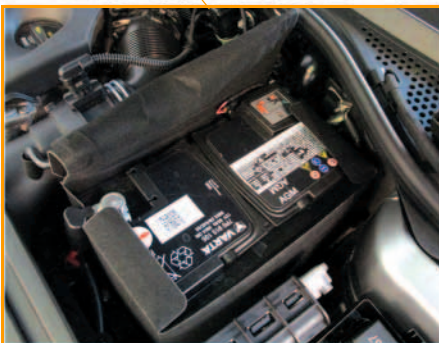
12V-Batterie im Motorraum
