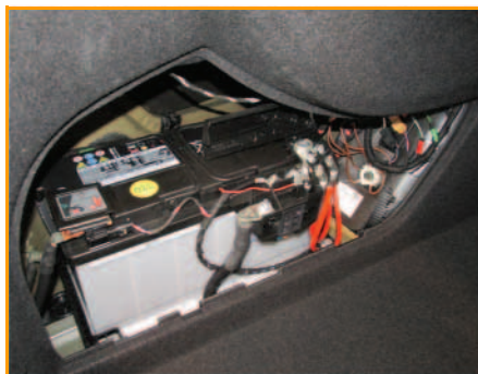
12V-Batterie im Kofferraum mit Hauptsicherungsbox
